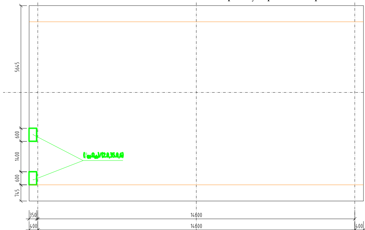
obr. 11 Postavenie zaťažovacieho modelu LM2 pre V_z – pri uložení dosky
